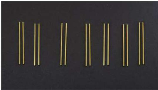
Quatorze tronçons de fil de laiton sont découpés (longueur 35 millimètres).
