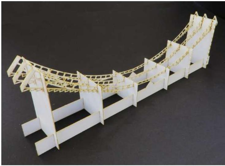
Les trois arches sont placées sur le gabarit d'assemblage.
