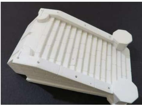
Les parapets des escaliers d'accès sont percés à 0.8mm suivant les repères, pour recevoir les rambardes.
